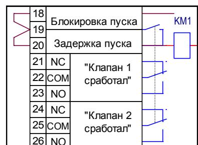
На практике, для управления вентилятором дымоудаления перемычку оставляют, а для управления вентилятором подпора перемычку удаляют (пуск с задержкой).
